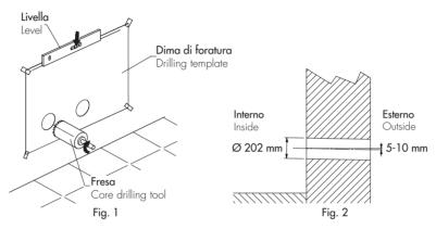
Piegare le alette del foglio di plastica in dotazione. Tagliare a misura i fogli in plastica a corredo per ricavare, arrotolandoli, due tubi della giusta misura (è necessario rilevare lo spessore del muro e sottrarre 40 mm per lasciare lo spazio necessario alle griglie). Inserire nei due fori i tubi di plastica ricavati, prestando attenzione alla linea di giunzione che deve sempre essere rivolta verso l'alto. Tagliare il tubo alla giusta lunghezza sull'altro lato del muro.
