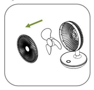
Hold the back of the fan and pull out the fan blades.
