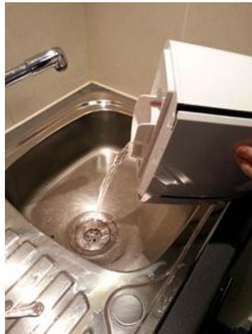
Um den Tank zu entleeren wiederholen Sie diesen Vorgang und leeren Sie das Wasser ab . Säubern Sie den Tank und entfernen Sie Ablagerungen.
