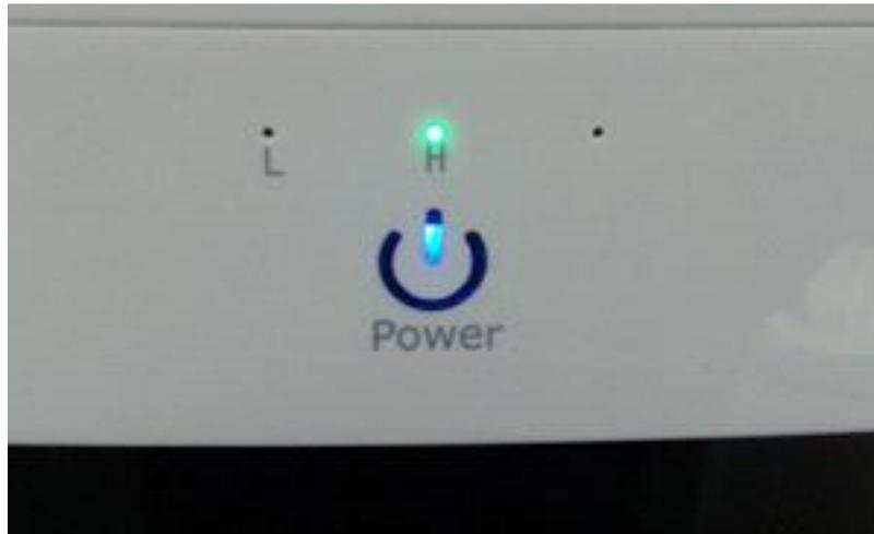
**Power** Drücke Sie einmal den Power-Knopf um den Befeuchter anzuschalten. Drücken Sie noch einmal, um zwischen schwacher und starker Befeuchtung hin und her zu wechseln.
